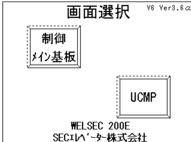
本書では2009年9月施行の改正建築基準法施行令で設置が義務付けられた、「戸開走行保護装置」（国土交通大臣認定）を UCMP と呼びます。\*戸開走行保護（Unintended Car Movement Protection）
