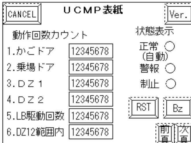
「CANCEL」：本釦で異常判定を停止します。再度釦を押すか、釦を押して4時間経過で異常判定を再開します。（工事・メンテナンス作業用）
