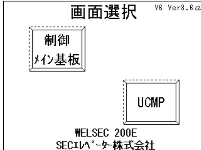
WELSEC200E\_CPU 基板と接続したとき、「制御メイン基板」釦で制御表紙画面を呼び出します。
