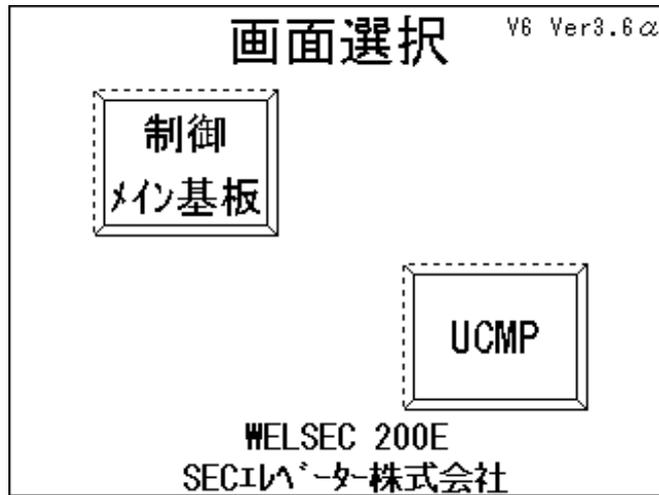
WELSEC200E\_CPU 基板と接続したとき、「制御メイン基板」：“(2)制御表紙”画面を呼び出します。
