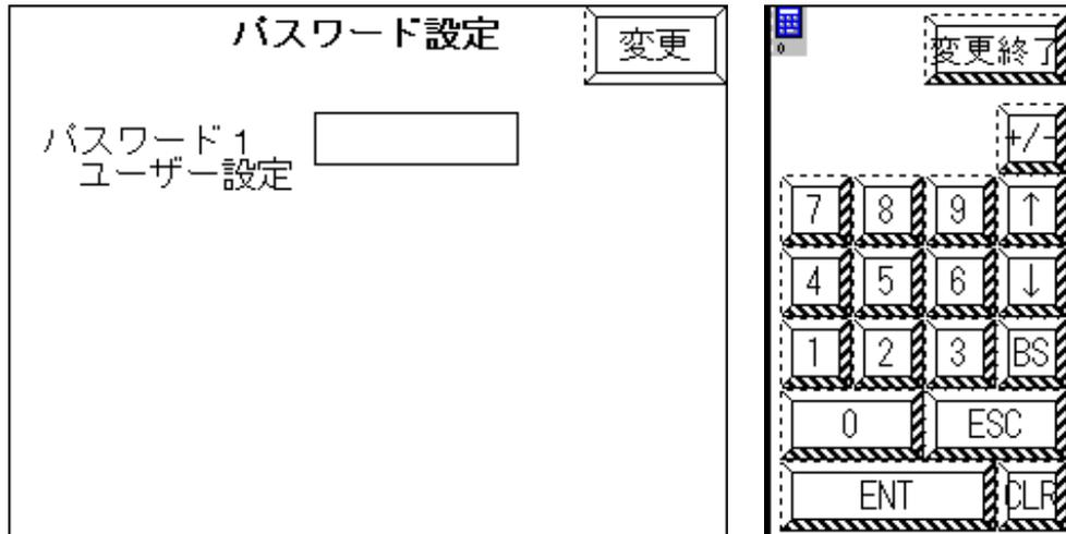
「変更」釦でテンキーが表示されます。テンキーで各パスワード（数字）を入力して、「ENT」キーを押すと指定された画面を自動的に表示します。
