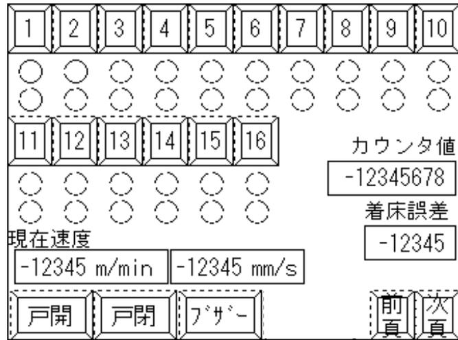
かご内の呼び釦と同等に、□の釦で1～16階床分の呼びを作ることができます（最下階を1としています）。○二段の表示は上段が前進階床（行先階床）、下段が現在階床を意味します。
